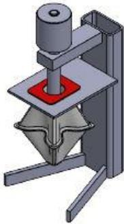
Abbildung 2 Skizzierter Prüfaufbau zur Bestimmung der Abzugsfestigkeit der Halteplatte
